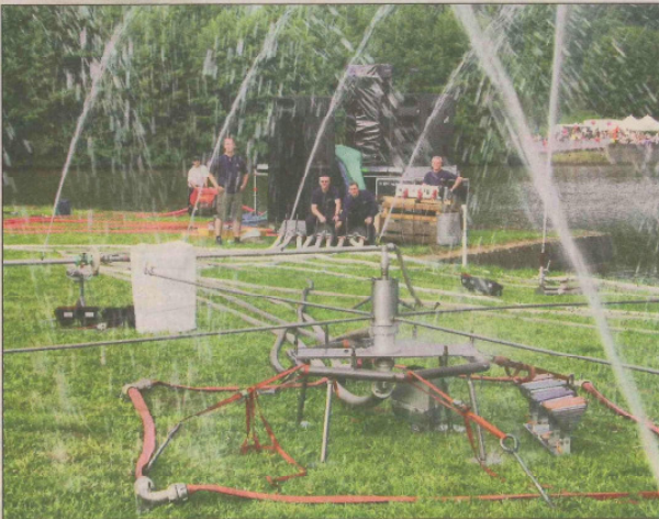
Testphase nach dem Aufbau. Es wird überprüft, ob alle Schläuche und Rohre die richtige Position haben und keine Düse verstopft ist. Inmitten steht ein Karussell mit Sprühdüsen.
